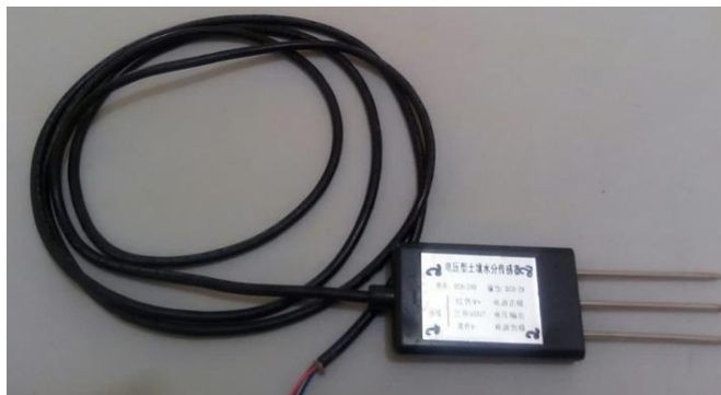
Figura 2. Sensor de umidade do solo Sonbest SM3001V2
