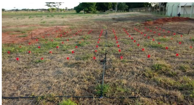
Figura 5. Coletores instalados em campo
