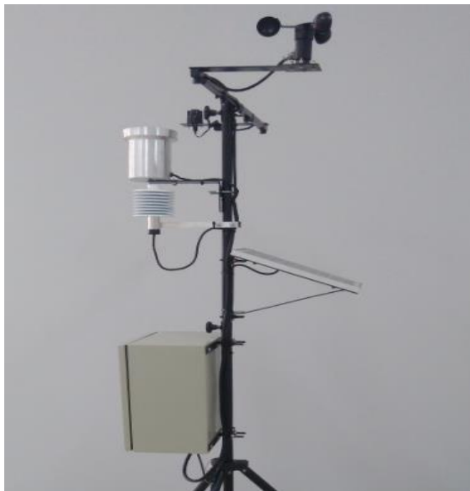
Figura 3. Estação meteorológica de baixo custo
